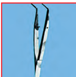
Ataque decapante parcial y depósitos de un medicamento para la hemostasis en la superficie del instrumento. Causa: exposición demasiado prolongada al contacto
