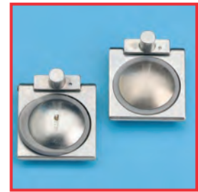
Derecha: Válvula de chapaleta de un trocar no hermética por hinchamiento de la junta, consecuencia del contacto con aceite. Izquierda: Nueva válvula de mariposa
