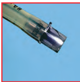
Grieta por tensión
