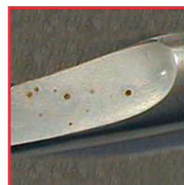
Ejemplo de corrosión de picadura
