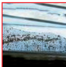
Ataque decapante parcial y depósitos de un medicamento para la hemostasis en la superficie del instrumento. Causa: exposición demasiado prolongada al contacto
