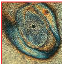
Ejemplo de corrosión de picadura
