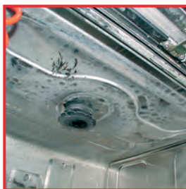
Cámara de aclarado con intensa calcificación
