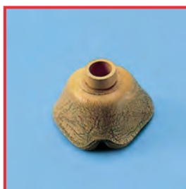
Grietas por envejecimiento en una mascarilla respiratoria
