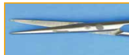
Izquierda: ataque parcial al material debido al uso de eliminador de cemento ácido, y en la derecha debido a tintura para el restañó de la sangre. Causa: tiempo de contacto demasiado elevado o limpieza insuficiente tras la utilización.
