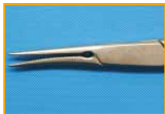
Deformación debida a manejo inadecuado
