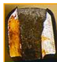
Detalle: Pinzas de boca partida con estructura fracturada intercrystalina granulada típica.
