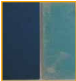
Izquierda: original Derecha: cambio del aspecto en el caso de aluminio metalizado
