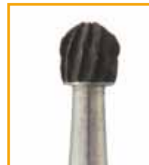
Broca de metal duro de WC/CO, corroída y gastada. Causa: utilización de un limpiador ácido.
