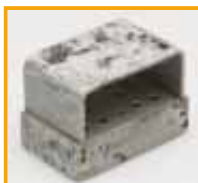
Fuerte ataque al material en superficies de aluminio natural o metalizado con un soporte de instrumentos o contenedor. Causa: sobredosificación de la solución de lavado normalmente compatible con el material.
