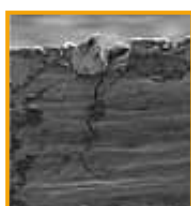
Detalle: articulación final de tijeras con hendidura intercrystalina típica.
