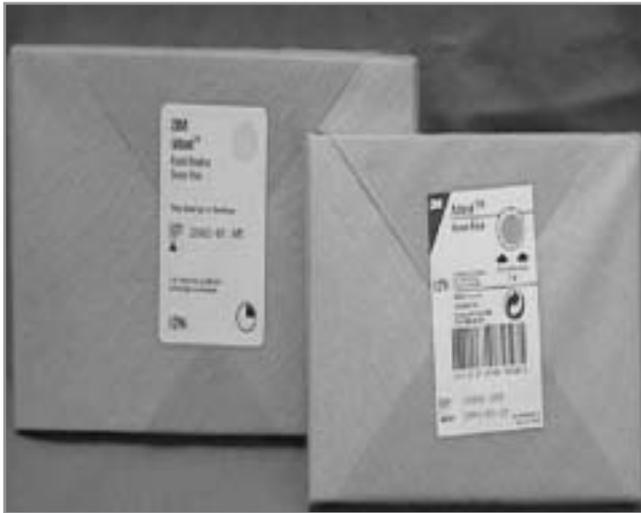
**Figura 10.** Paquetes desechables con indicadores biológicos con lectura a las 48 horas y rápidos de 3 horas.
